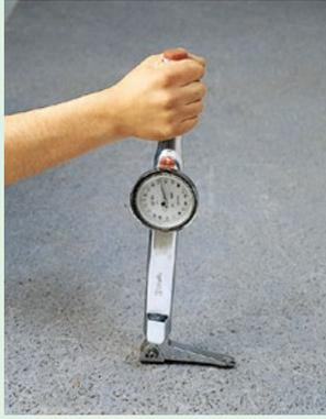
▲簡易引き抜き試験機
