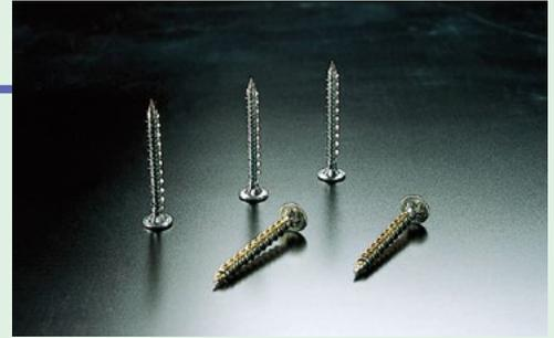
屋根葺材の留付けはビス使用ですが、ビスの形状により効きが大きく異なります。また、トルクの大きいドライバーを使った場合、ネジ切ってしまう恐れがあります。トルクの小さいドライバーを使用するか、ストッパーを取り付け調整して下さい。ビス、ドライバーについてのご相談は本社営業部まで。
